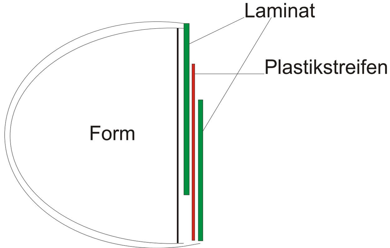
Kann nach dem Aushärten entformt, beschnitten und wieder geklebt werden
