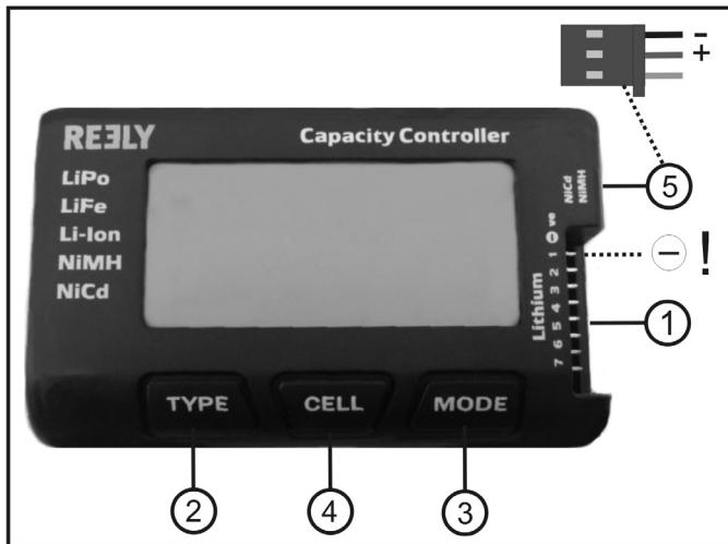
1 Aansluiting voor Lithium-accu
