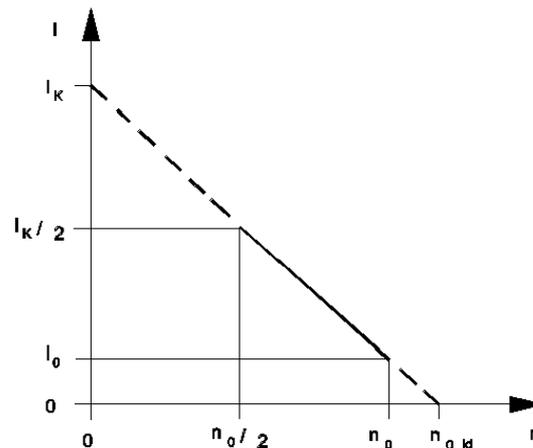
Im Diagramm mit den Achsen  $n$  und  $I$  stellt sie eine Gerade dar, die für  $n = 0$  mit dem Wert  $I_K$  beginnt und mit wachsender Drehzahl  $n$  mit der Steigung  $k_e/R$  abfällt.
