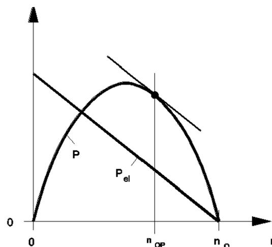
Wird –vom Leerlaufpunkt  $n_0$  ausgehend- die Drehzahl verringert, dann wächst die relative Eingangsleistung  $P_{el}$  gleichförmig an. Die relative Ausgangsleistung wächst zunächst wesentlich stärker an. Wird die Drehzahl weiter verringert, dann wird die Zunahme der Ausgangsleistung als Folge der gekrümmten Kurve immer geringer, während die Zunahme der Eingangsleistung gleich bleibt.
