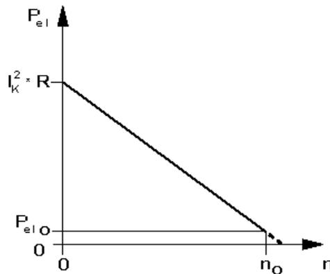
Sie beginnt bei  $n = 0$  mit dem Wert  $I_k^2 \cdot R$  und endet bei  $n = n_0$  mit dem Wert
