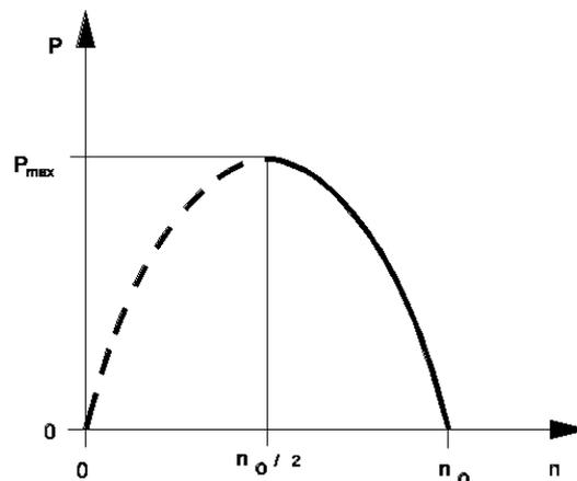
Formel (27) stellt in einem Diagramm mit den Achsen  $n$  und  $P$  eine Parabel dar. Mit Hilfe der Differentialrechnung kann man zeigen, daß die maximale Abgabeleistung genau bei  $n_0/2$ , d.h. bei der halben Leerlaufdrehzahl erfolgt. Auch hier ist nur der Bereich zwischen  $n_0/2$  und  $n_0$  von Interesse. Links vom Maximum geht die Ausgangsleistung wieder zurück; andererseits steigen aber Strom und Eingangsleistung weiter an; der Motor würde zum "Heizofen".
