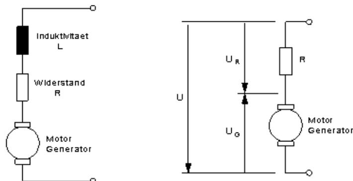
Die (Wicklungs-) Induktivität können wir im Folgenden übergehen, obwohl sie bei der "getakteten" Ansteuerung sowie in den Details der Kommutierung von BL-Motoren eine sehr große Rolle spielt. Es soll eine nicht getaktete Betriebsspannung, d.h. Vollast-Betrieb angenommen werden. In diesem Fall kann man die Induktivität unberücksichtigt lassen.
