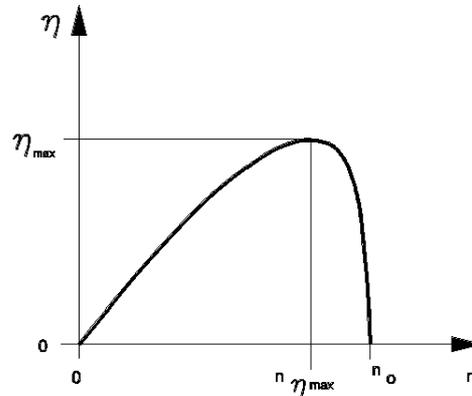
Beginnend mit  $\eta = 0$  im Stand, steigt die Kurve zunächst fast linear mit der Drehzahl an, biegt dann mehr und mehr ab, und erreicht bei der Drehzahl  $n_{\eta_{max}}$  ihr Maximum. Mit weiter wachsender Drehzahl fällt sie dann bis zur Leerlaufdrehzahl  $n_0$  hin steil ab bis auf Null.
