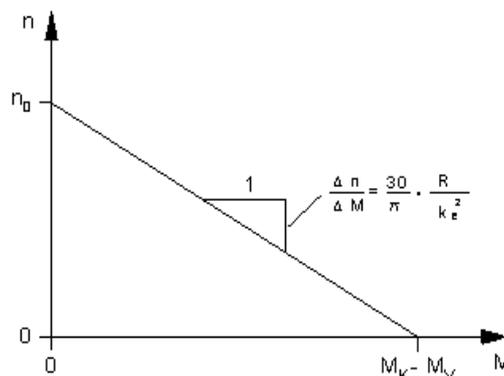
Hier haben wir jetzt den Kehrwert als Steigung, nämlich  $\Delta n/\Delta M$ . Das ist ein Maß für die "Steifigkeit", die der Motor einer Laständerung entgegensetzt, d.h. die Drehzahländerung pro Drehmomentänderung.
