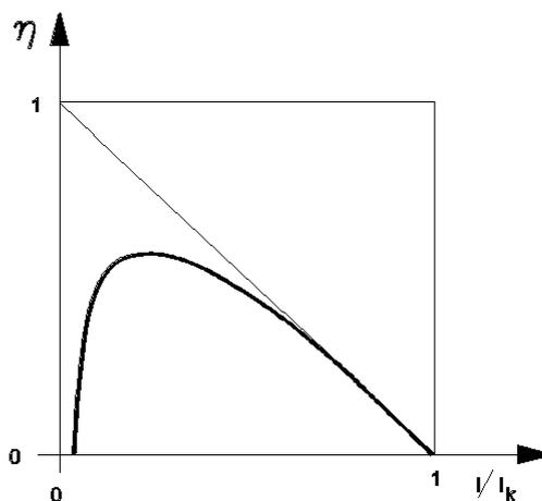
**Da der Wirkungsgrad eines realen Motors immer schlechter als der eines (halb-)idealen ist, bedeutet dies, daß die Wirkungsgradkurve immer unterhalb der Diagonalen verlaufen muß.**
