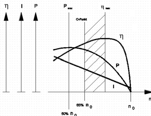
Nur in dem schraffierten Bereich zwischen den Drehzahlen des O-Punktes und des besten Wirkungsgrads ist der Motor sinnvoll zu betreiben. Wenn die Motorparameter  $k_e$ ,  $k_L$  und  $R$  sowie die Betriebsspannung bekannt sind, können mit den angegebenen Formeln diese Drehzahlen, die zugehörigen Ströme usw. berechnet werden.
