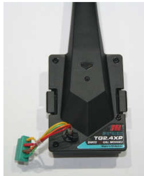
Die Oberseite des Sendermoduls. Die Anschlussdrähte habe ich durch die Bohrung des Bindetasters hindurch nach außen geführt. Der orange, der rote und der braune Draht sind für den Anschluss des VSpeak Sprachausgabemoduls. Der gelbe und der grüne Draht ersetzen den Bindetaster des JR Sendermoduls.
