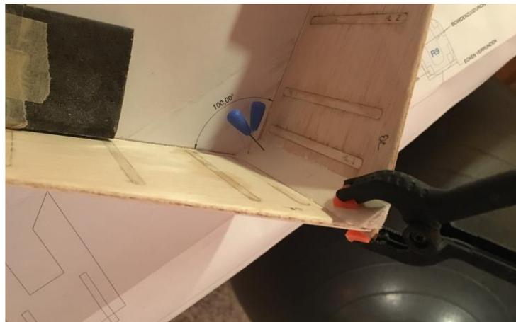
Auf den Rumpf geklebt wird das Leitwerk erst nach dem Bespannen! Hierfür wieder Weißleim oder Epoxydharz verwenden. **Die Folie an der Klebestelle unbedingt entfernen!!!**
