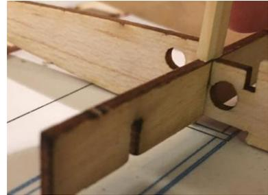
Das Bild zeigt die Rippe am Kopf stehend und mit Hilfe einer Kieferleiste wird der Verkastungskamm vorsichtig in Position gedrückt.
