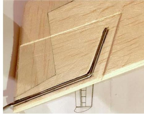
Auf den Stahldraht wird dann später ein Kugelkopf angelötet und der Bowdenzug eingehängt.
