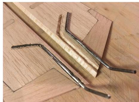
Um keine oberflächliche Stufe durch das SP zu bekommen, kann diese Verstärkung beim Übergang in das Ruderblatt eingelassen werden.
