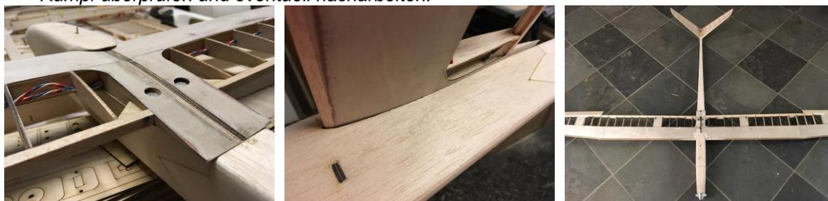
Die Querruder können beim Bespannen, mittels Folienscharnier, mit angebügelt werden. Wie das funktioniert wird weiter unten beschreiben. Dadurch ist ein spalt- und verzugsfreier Übergang von Fläche auf Ruder gegeben.
