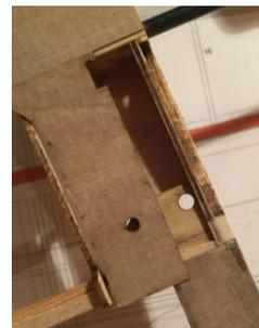
Die Flächenhälfte ist somit rohbaufertig und kann für's Folieren fein überschliffen werden. Die Stützfüße für das Schleifen der Unterseite nun abtrennen!
