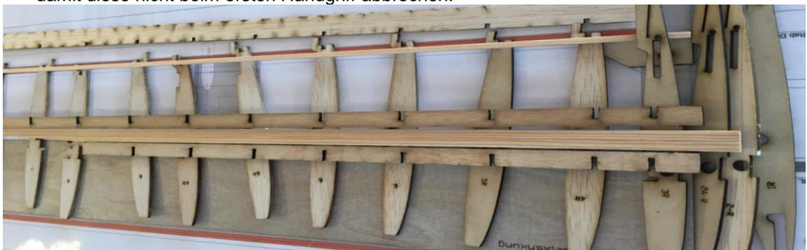
Grundsätzlich gilt auch, dass die Rippenfüsse immer wieder angeklebt werden sollen, wenn diese abbrechen. Nur dadurch bekommt man einen verzugsfreien Flächenaufbau. Ebenso sollen die Füße nicht mit der Hilfsleiste verklebt werden.
