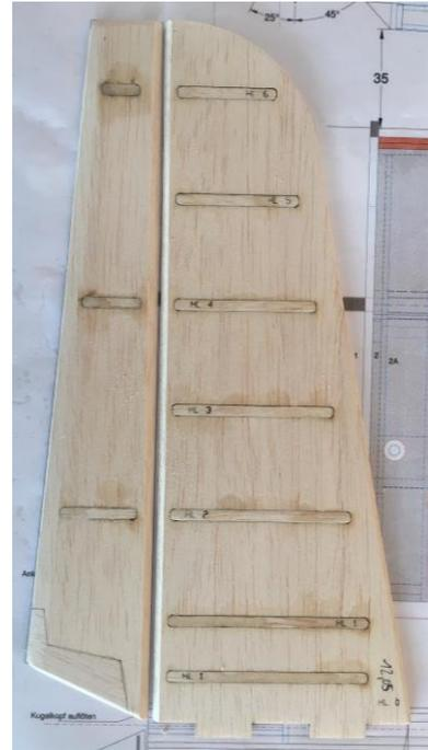
Leitwerkshälften zusammenstecken und den Öffnungswinkel lt. Schnitt am Plan einstellen. Leitwerk hierfür auf den Plan stellen und ausrichten. Leitwerkshälften mit Sekundenkleber zusammenkleben. Die Leitwerksaussteifung – Balsadreiseckleiste - mit Leim einkleben.
