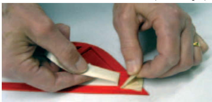
Links und rechts Klebeband nochmals lösen und Abdeckband-Fixierung entfernen, dann erneut andrücken.
