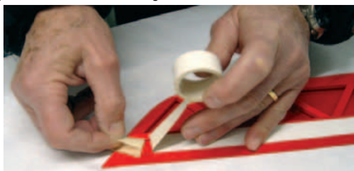
Links und rechts Klebeband nochmals lösen und Abdeckband-Fixierung entfernen, dann erneut andrücken.
