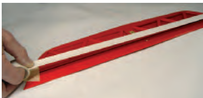
Mit stabilem, nicht zu weichem Klebeband, (ev. 2-3 Lagen) Spalt überdecken und sehr gut andrücken.
