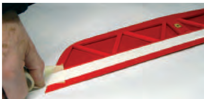
Mit stabilem, nicht zu weichem Klebeband, (ev. 2-3 Lagen) Spalt überdecken und sehr gut andrücken.
