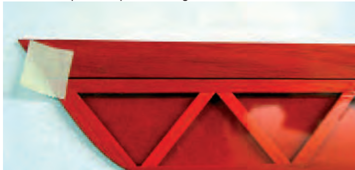
Ruder und Fläche mit Abdeckband fixieren, abwechselnd links und rechts korrigieren bis ein 1-2mm Spalt vorhanden.
