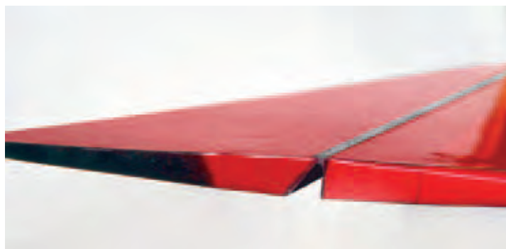
Hier das fertige Silikon-Ruderscharnier an einem gewöhnlichen, Oracover-Light bespannten Rippen-Höhenruder.
