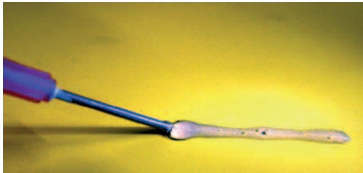
Silikon-Raupe mit Spritze und gekürzter 1,2mmØ Nadel ...
