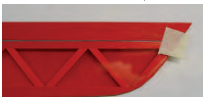
Ruder und Fläche mit Abdeckband fixieren, abwechselnd links und rechts korrigieren bis ein 1-2mm Spalt vorhanden.
