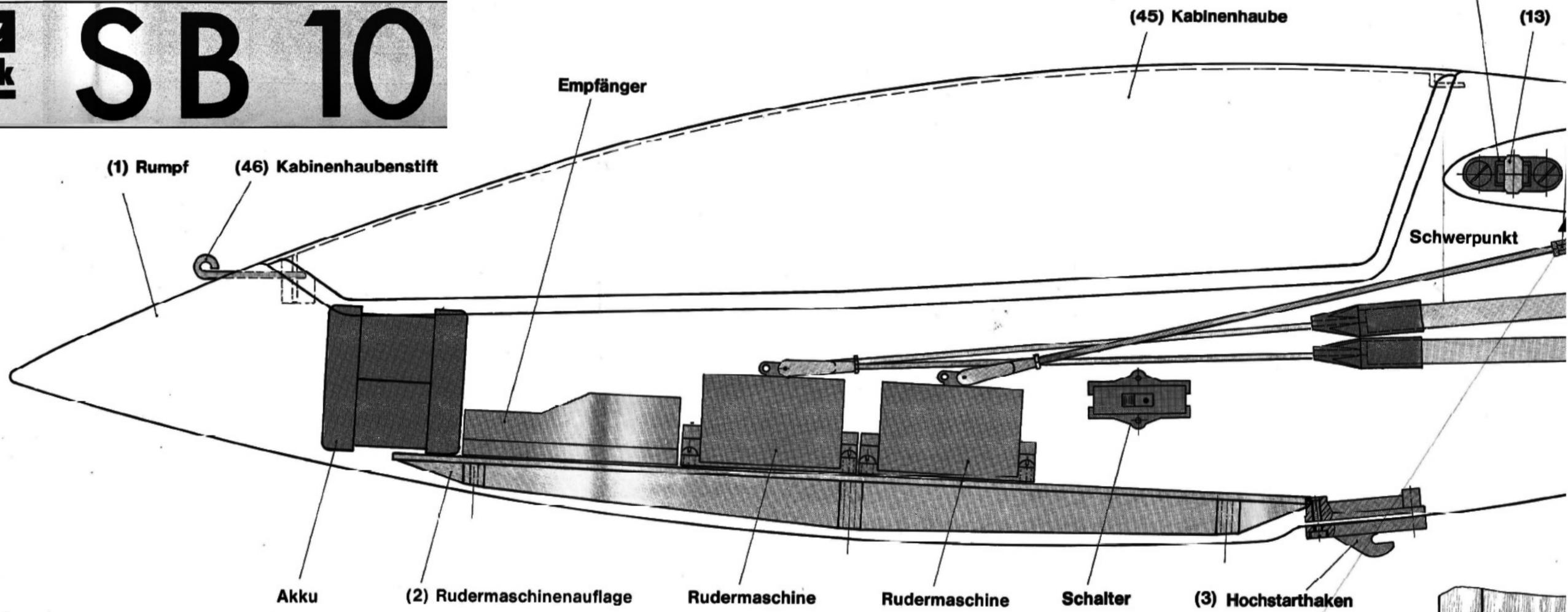
Die jeweils zur Verwendung kommende Funkanlage wird die entgültige Position von Akku und Empfänger bestimmen. Sie gelten im Plan als schematische Darstellung.
