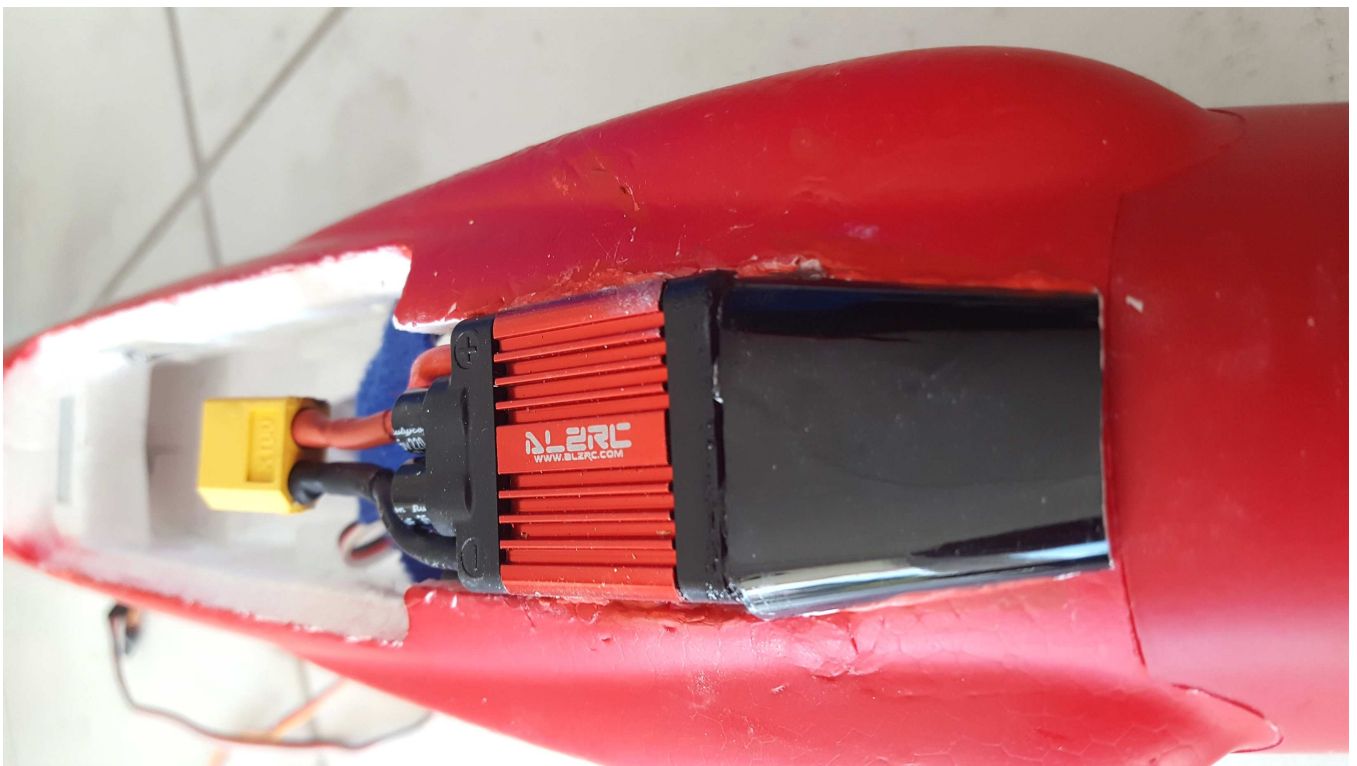
Bild 3: Durch die Verlagerung des Gewichtes nach vorne, konnten die Servos nach hinten verschoben werden. Die nutzlose Carbon-Verstärkung in der Rumpfmittle wurde im Servobereich durchtrennt und durch einen 3x0,5mm Carbonstab am Rumpf unten, welcher den Rumpf auch wirklich versteift, ersetzt.
