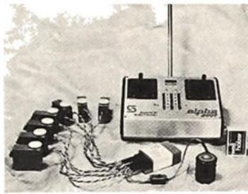
Die Simprop alpha 2007/7 erlaubt den Anschluß von sieben Servos (oben). Der Empfänger ist sehr klein und leicht, da die Servoelektronik in die Servos eingebaut ist. Der Nachteil ist ein wesentlich höherer Preis der Servos.
