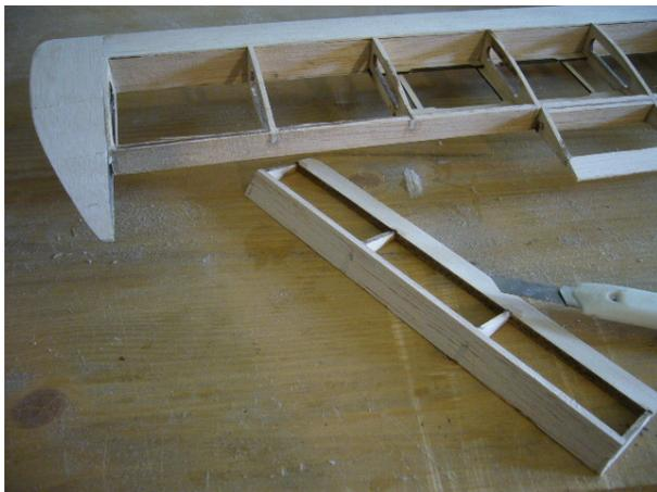
1. Das Ruder wird wie gewohnt ausgetrennt. Der Winkel zwischen Holm und Querruderleiste ermöglicht später einen ausreichend großen Ausschlag nach unten.
