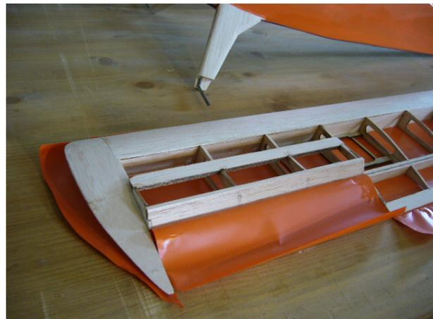
2. Die Tragfläche wird auf der Unterseite bespannt, und das Ruder umgedreht auf die Oberseite gelegt.
