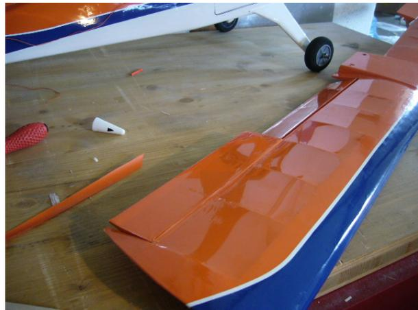
8. Auch die restliche Folie auf der Tragfläche wird gespannt. Man erhält eine (auf der Oberseite) spaltfreie Anlenkung die keine störenden Einflüsse auf den Luftstrom hat.
