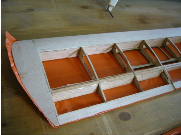
5. Das Ruder wird heruntergeklappt und es kann mit dem Bespannen an der Oberseite der Tragfläche begonnen werden
