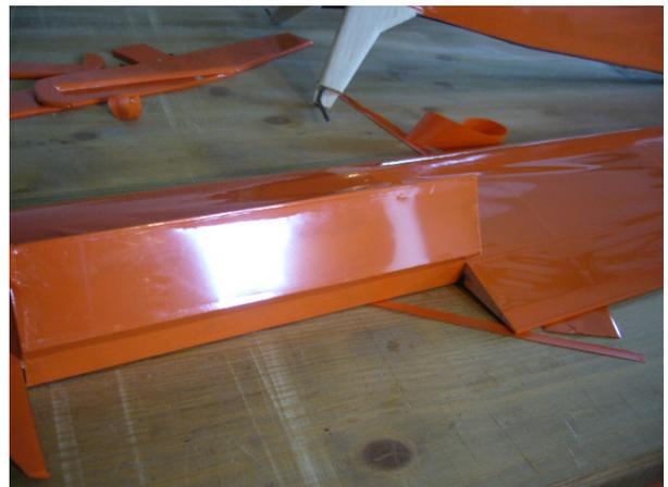
4. Mit etwas weniger Hitze wird der Rest der Unterseite des Ruders bebugelt und dann mit mehr Hitze die Folie gespannt.
