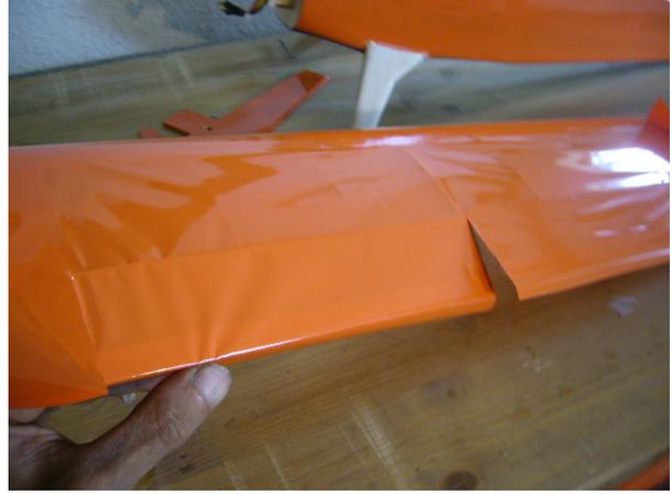
6. Die Folie auf der Oberseite wird nun locker mit wenig Hitze angeheftet und eingeschnitten. Das Ruder muß komplett nach unten ausgelenkt und gehalten werden. Die Folie am Drehpunkt und an der Endleiste wird mit geringer Hitze angeheftet.
