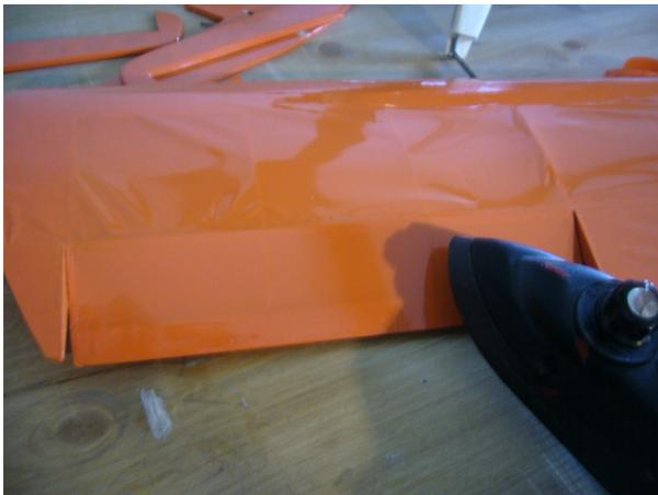
7. Das Ruder weiterhin nach unten auslenken und die Folie mit Hitze spannen. So zieht die Folie das Ruder nicht bereits beim spannen/schrumpfen nach oben !
