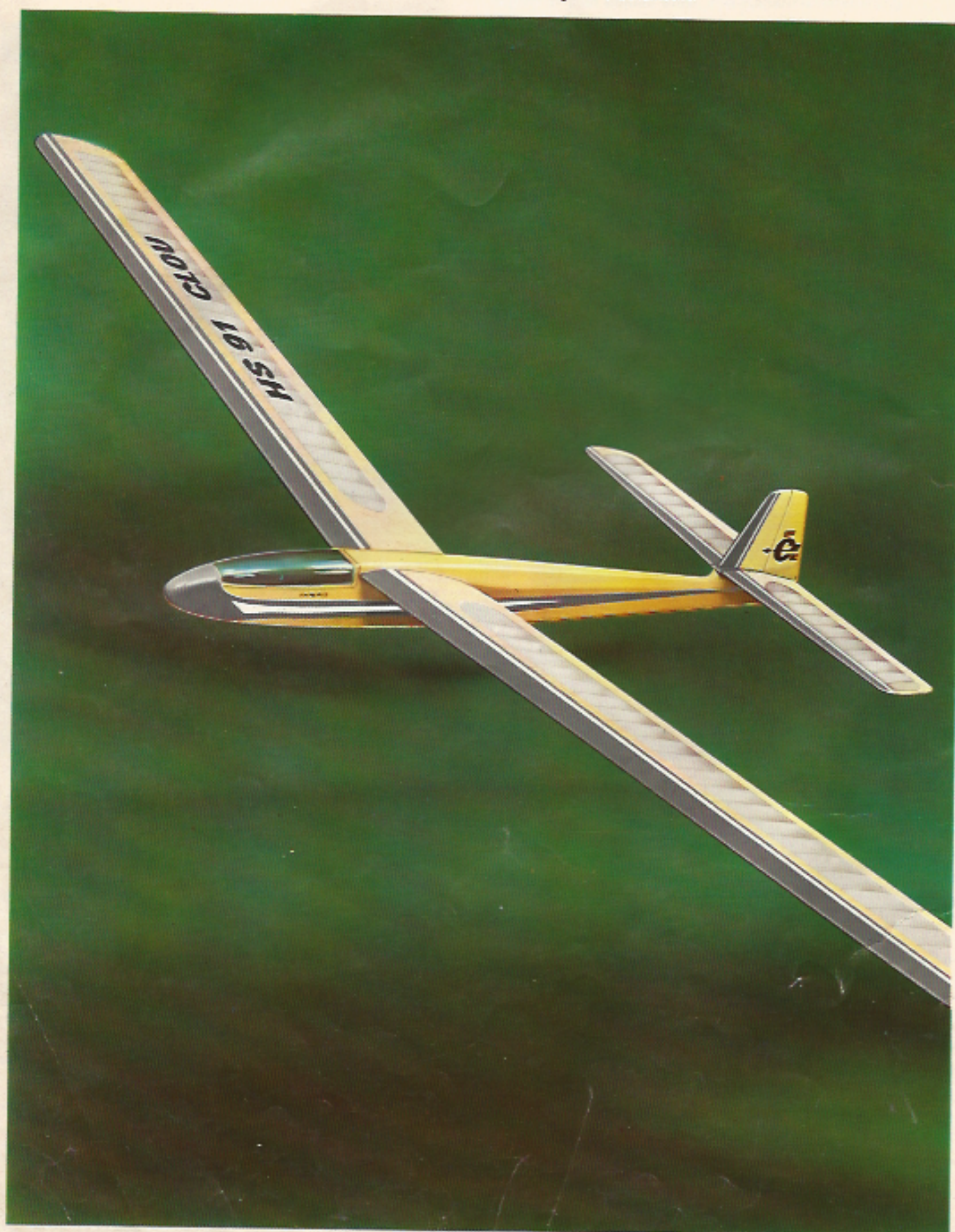
HS 91 CLOU, Spannweite 2450 mm, als Thermiksegler
