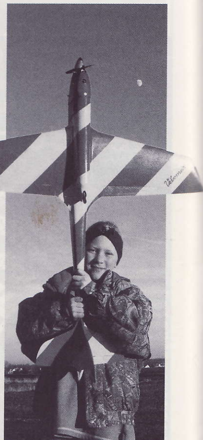
»Velomax« in seiner Erstflugkonfiguration, noch mit kurzer aerodynamischer Verkleidung und dem Graupner-Rohr Best.-Nr. 2228
