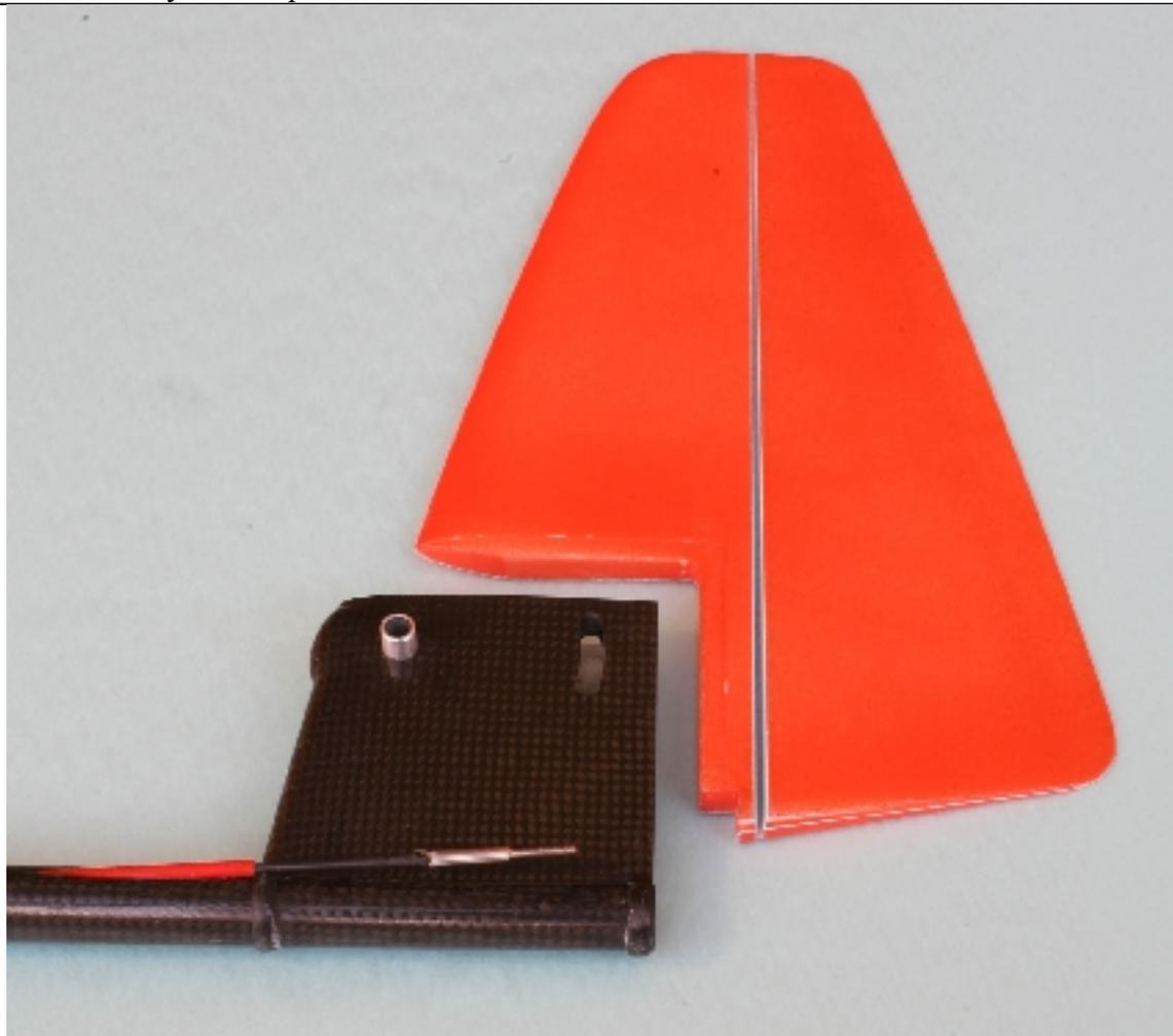
Киль съёмный при транспортировке. Он вставляется в щель блока крепления стабилизатора и фиксируется клейкой лентой.
