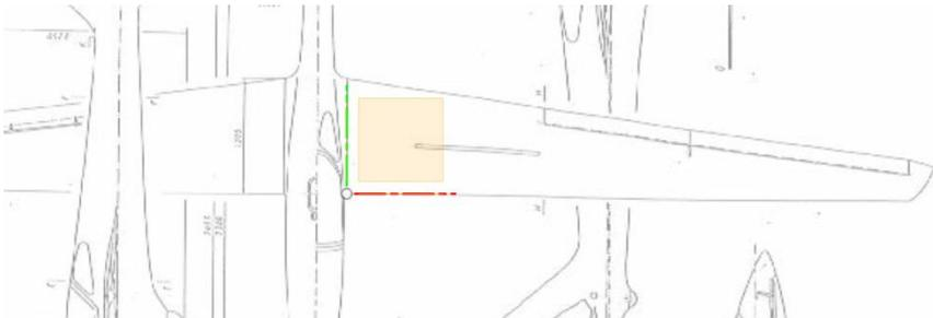
Dabei wählen wir die LINKE Tragfläche aus (sonst müssen später alle importierten Profile um 180° in der Z-Achse gedreht werden) und positionieren die Nasenleiste direkt an der X-Achse und die Wurzelrippe direkt an der Y-Achse. Dann ist „Oben“ tatsächlich oben und „Vorne“ tatsächlich vorne.
