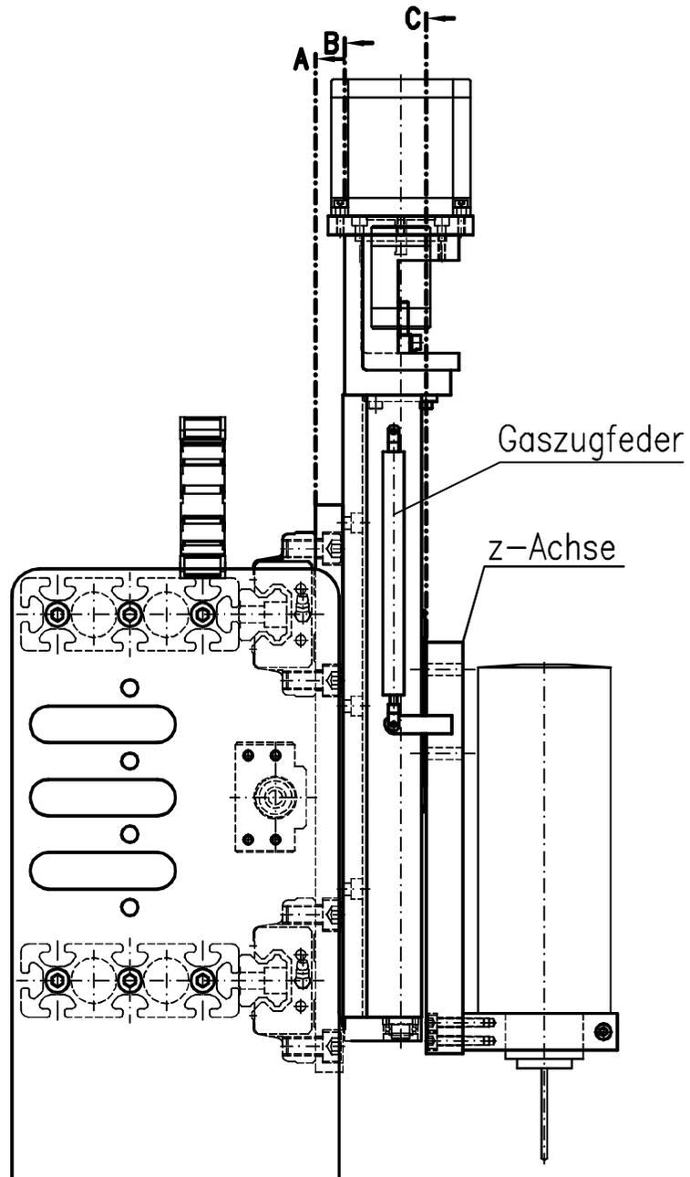
Gaszugfeder auf Gewicht und Hub der z-Achse auslegen.
