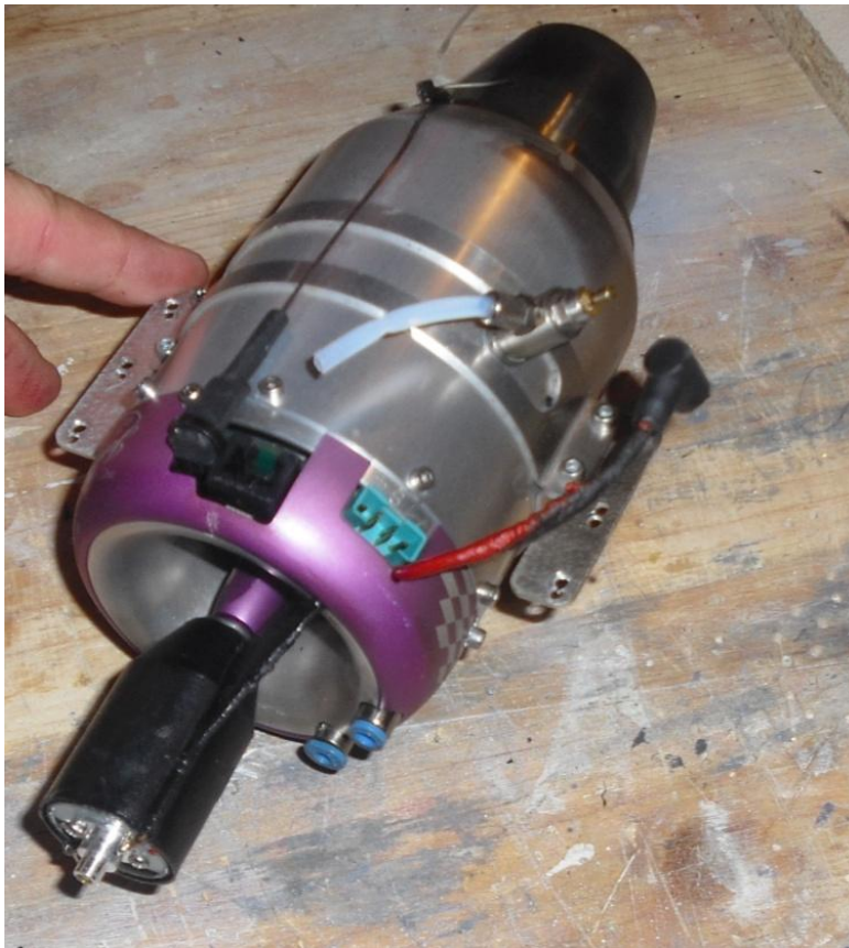
Abbildung 5 Zustand des Triebwerkes nach der Havarie. Die Kappe des Starters ist zur Inspektion abgenommen.
