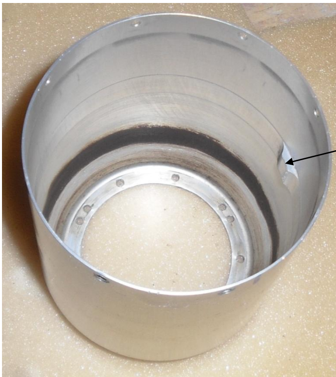
Abbildung 4 Brennkammergehäuse nach Reinigung
