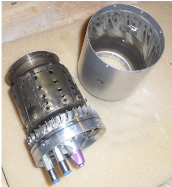
Abbildung 1 zerlegtes Triebwerk nach Kauf
