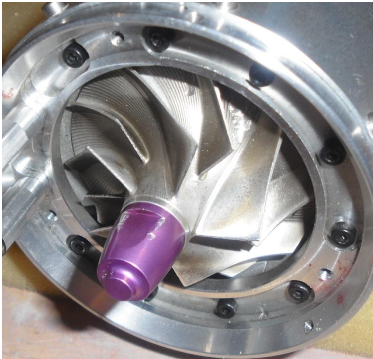
Abbildung 6 Zustand des Verdichters nach dem abschleifen der Laufschaufelvorderkanten
