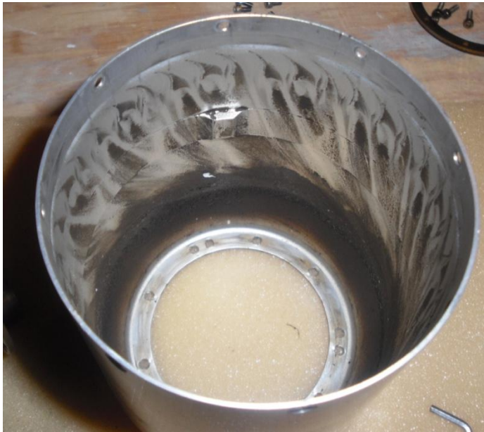
Abbildung 3 Ablagerungen innen im Brennkammergehäuse
